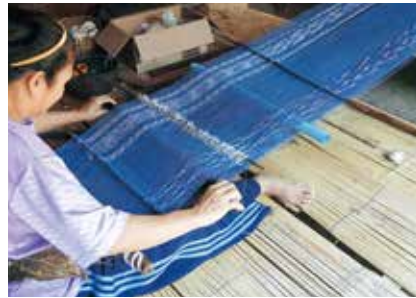
腰にベルトを巻いて経糸を固定し、全身を伸縮させて織る
